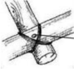
Detalle de unión de maderas de la viga solera
