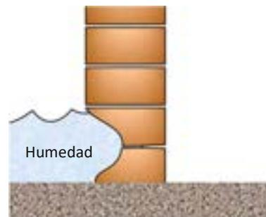
Erosión de la parte baja de los muros por la humedad y la falta de cimientos aumenta el riesgo de las viviendas.
