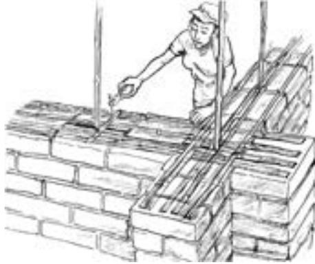
Muro reforzado con caña vertical y horizontal (Norma E80 Adobe)
