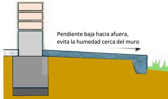
Vereda de mezcla de concreto sobre cama de piedras medianas de 4" (10 cm) con una pequeña inclinación hacia afuera de la vivienda
