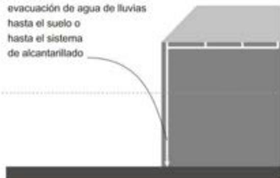
Esquema de evacuación de agua de lluvias en el techo (RNE, Norma A 020 Artículo 23)
