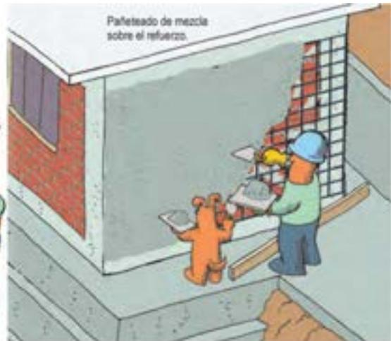
Reforzo de muros con malla electrosoldada colocada por ambas caras, ancladas y tarrajeadas (PREDES, 2021).
