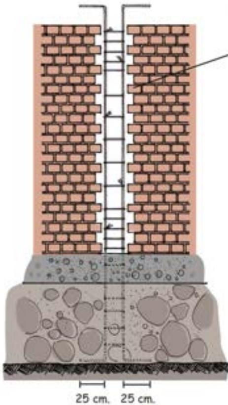
Conexión entre columna de amarre y muros portantes de albañilería (PUCP, SENCICO, 2017)
